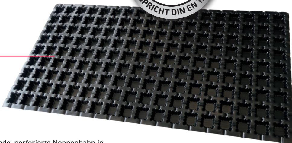
PM P-40 200 ist eine wasserspeichernde, perforierte Noppenbahn in Plattenform und empfiehlt sich als ideale Lösung für die intensive Dachbegrünung. Gegenüber herkömmlichen Gründachprodukten bietet sie ein Vielfaches an Drainage- sowie Wasserspeicherkapazität und übernimmt im intensiven Gründach die Funktion einer extrem leistungsfähigen Drainage- und Wasserspeicherschicht.
